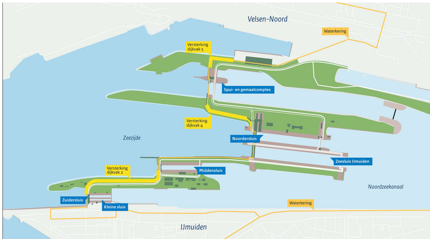
Indeling van het sluizencomplex IJmuiden
