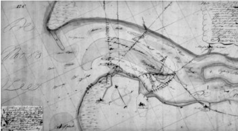
Afb. 2. Verzanding van de Maasmond. Ten behoeve van de scheepvaart voor Rotterdam bracht Ancelin de ondiepten tussen De Beer en de vijf sluizen voorbij Vlaardingen in kaart, met vermelding van diverse peilinggegevens. In de toelichting staat in welke richting de zandplaten zich verplaatsen. Een aan Ancelin toegeschreven ingekleurde pentekening, in 1696 vervaardigd op papier, 42,5x105 cm, schaal circa 1:27.700 (GAR, Rotondetekeningen, portefeuille L nr. 39).
