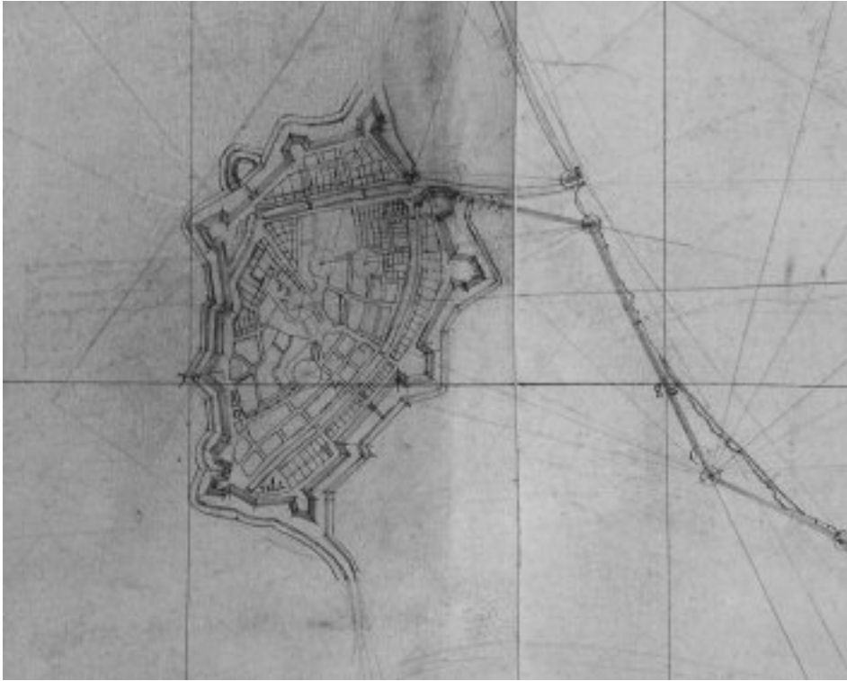
Afb. 18. Vaste meetpunten in en nabij Brielle. Juist de coördinaten van de op afstand zichtbare vaste referentiepunten in en om Brielle zijn uiterst nauwkeurig, in uitsluitend verticale projectie, vastgelegd. Manuscriptkaart in 1697 vervaardigd door Pierre Ancelin, op perkament, 133x265 cm, schaal circa 1:7.200 (kaarten-collectie GAR, Rotondelek. portef. L nr. 41a).
