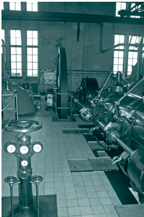
Afb. 3. Overzicht machinehal: vliegwiel, hoge en lage drukcilinder en kantoormuurtjes. Foto auteur.
